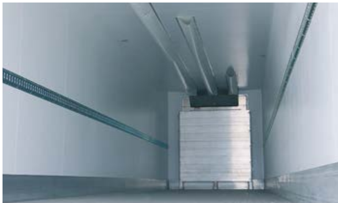
Комплектация с ХОУ, с защитой ХОУ, с рукавами охлаждения, с системой рейлингов
