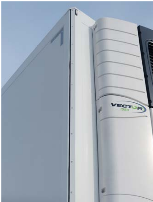
Двусоставные угловые профили передней стенки с zip-замками и кабель-каналом
