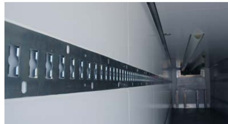
Утопленные нижние боковые профили в панели боковых стенок
