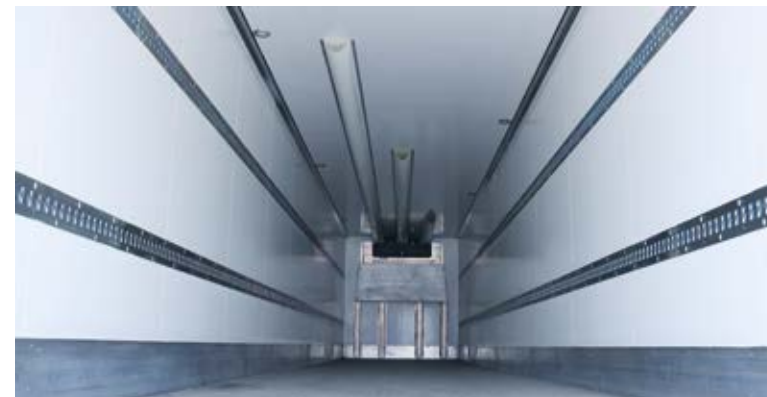
Утопленные такелажные рейки без разрыва панелей
