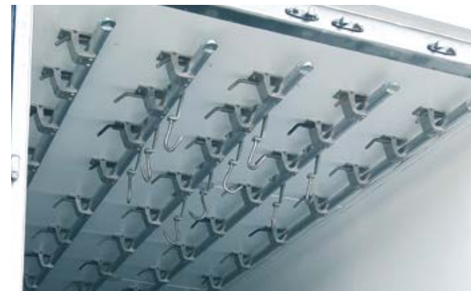
Комплектация с ХОУ, с защитой ХОУ, с системой для перевозки полуприцепов в подвешенном состоянии
