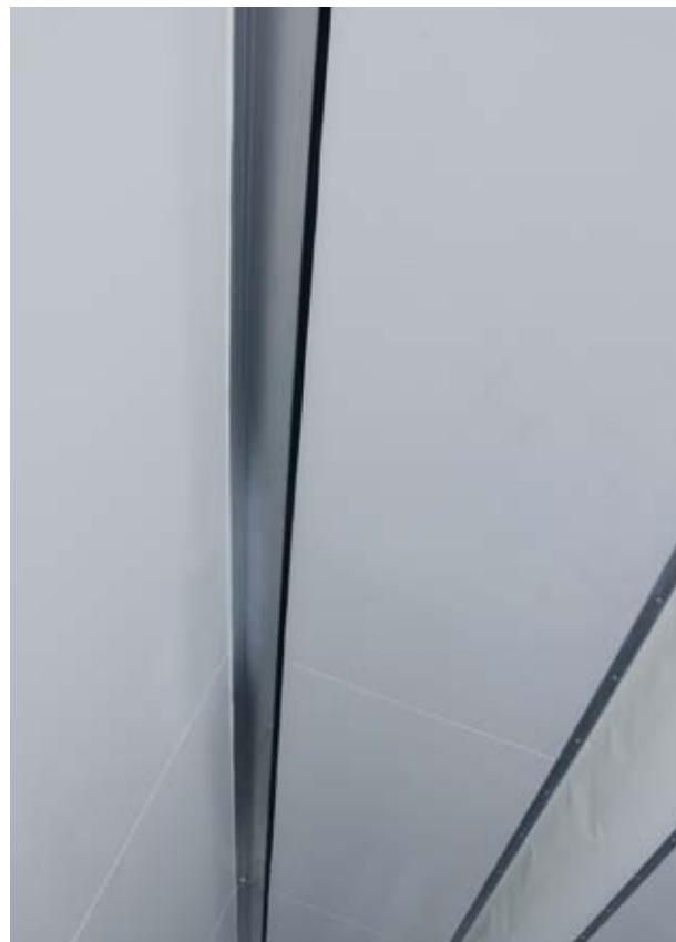
Верхние внутренние уголки крыши с интегрированным кабель-каналом для прокладки дополнительной проводки внутри кузова с резиновым уплотнителем
